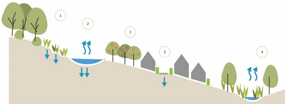
Dombvidéki laza települési szerkezet sematikus metszete és az alkalmazható megoldások (Forrás: saját szerkesztés)
